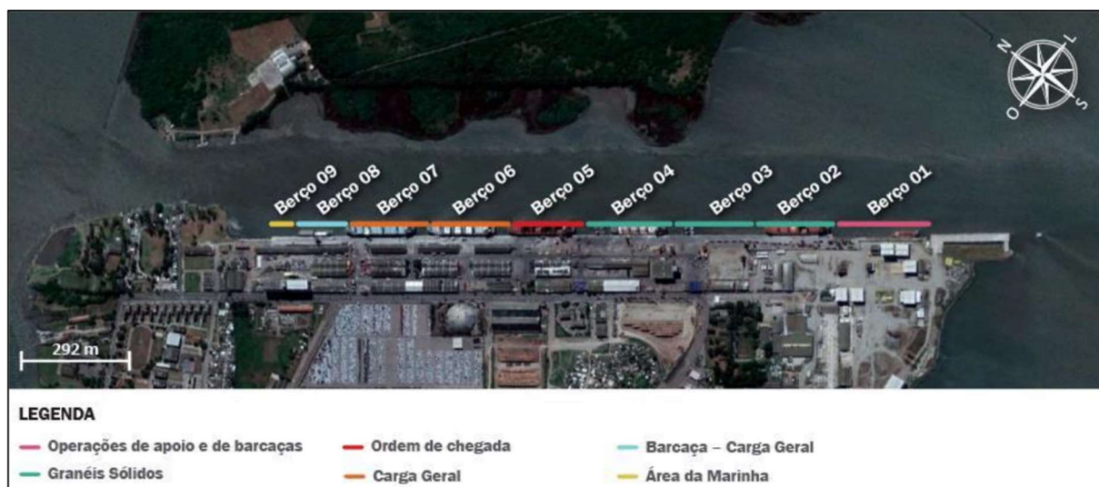
Figura 11 - Disposição dos berços do Porto Novo do Porto do Rio Grande.
